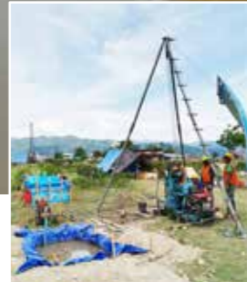
液状化が発生した地域ではボーリング調査を継続中。対策として、水抜き井戸の建設も計画されている。
