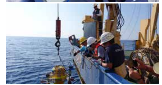
上：最先端の無人海洋観測装置(海上ドローン)も使って、海底を測地し、地殻変動の観測を行う。下：ゲレロ州沖合にて、海底観測のための海底地震計と海底圧力計が海に沈められた。
