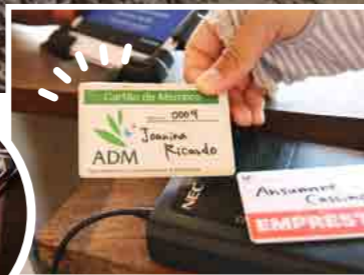
NECの電子マネーシステム。タブレットとICカードをタッチしてデータを読み込む機械、ICカードの三つで運用する。
