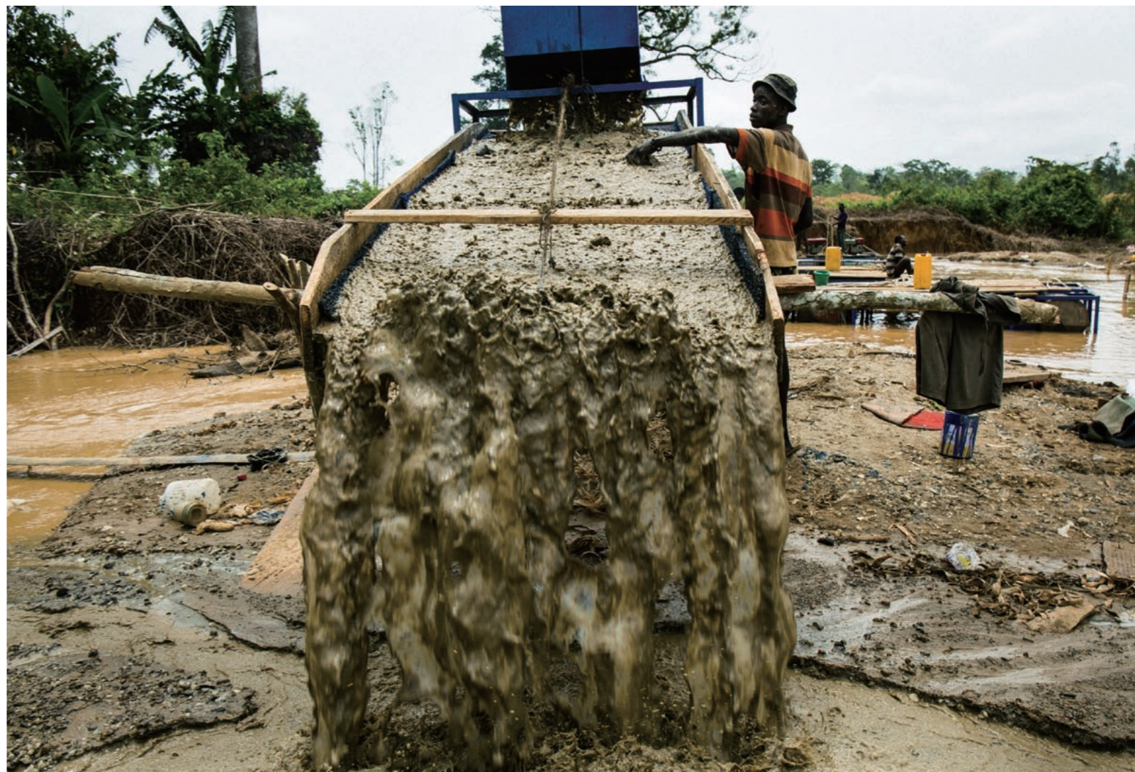
金の選別機。金を含んだ泥水を流すと、重い金は沈み、底に敷いている網に絡め取られるという仕組みだ。泥水はそのまま川に流されるので汚染の原因ともなる
