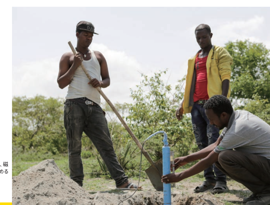
国立公園で行われた地表調査で、磁気を測定するセンサーを地中に埋めるGSEのカベデさん（手前）
