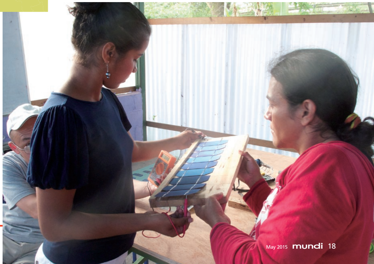
発電用のパネルをハンダで直列につなぐ。ソーラーパネルの仕組みは単純だ
