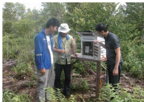
泥炭地に設置されたセンサー。地下水位が下がると土地が乾燥し、火災が発生しやすくなる
