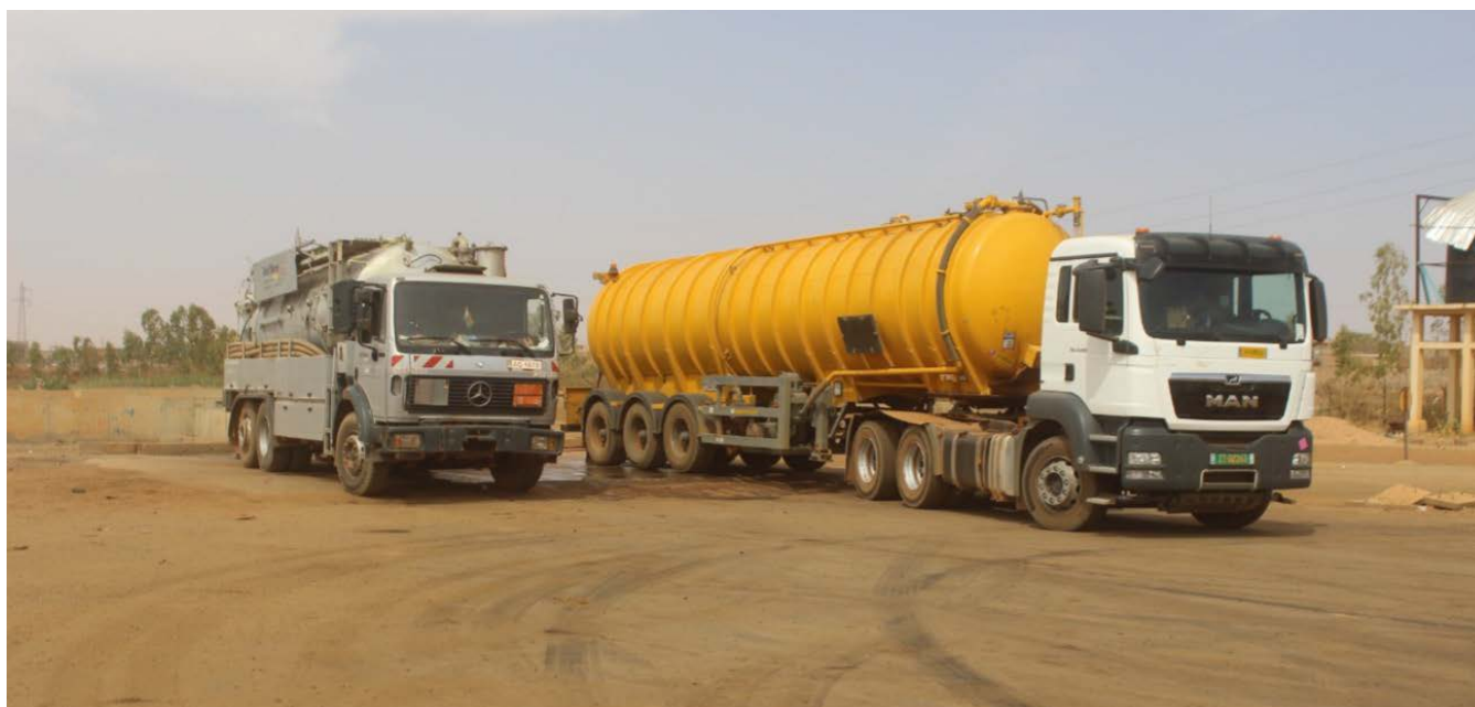
下水を搬入するバキュームカー。左の中型バキュームカーは12m 3 、右側の大型バキュームカーは33m 3 。 大型車が運搬するのはディオリ・ハマニ、ニアメ国際空港の下水です。
