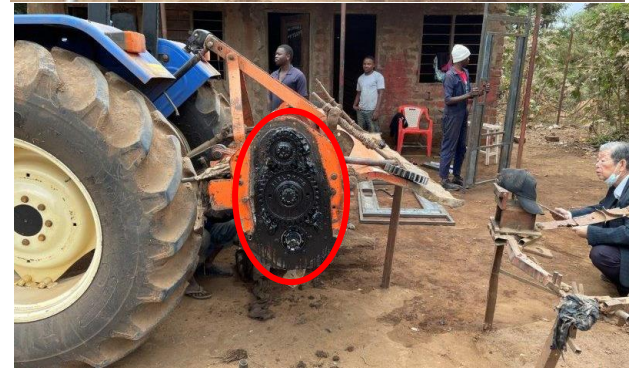
ロータリーを修理する様子。ドライブギアが欠けていた。(赤丸)
